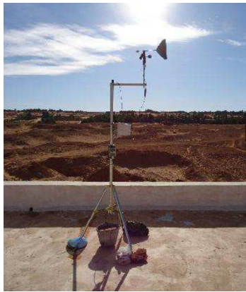
Figure 2: Station de référence placée sur la terrasse de l'hôtel sable d'or à plus de 10 m du sol.
