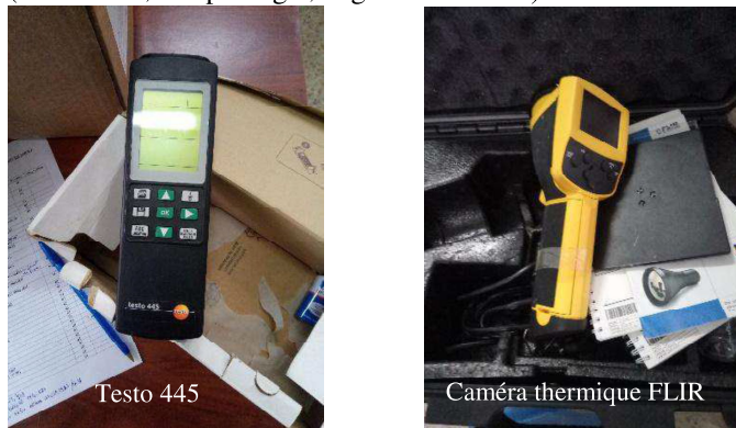
Figure 3: Instruments de mesures ponctuelles ayant servi pour les campagnes de mesures sur le site d'étude
